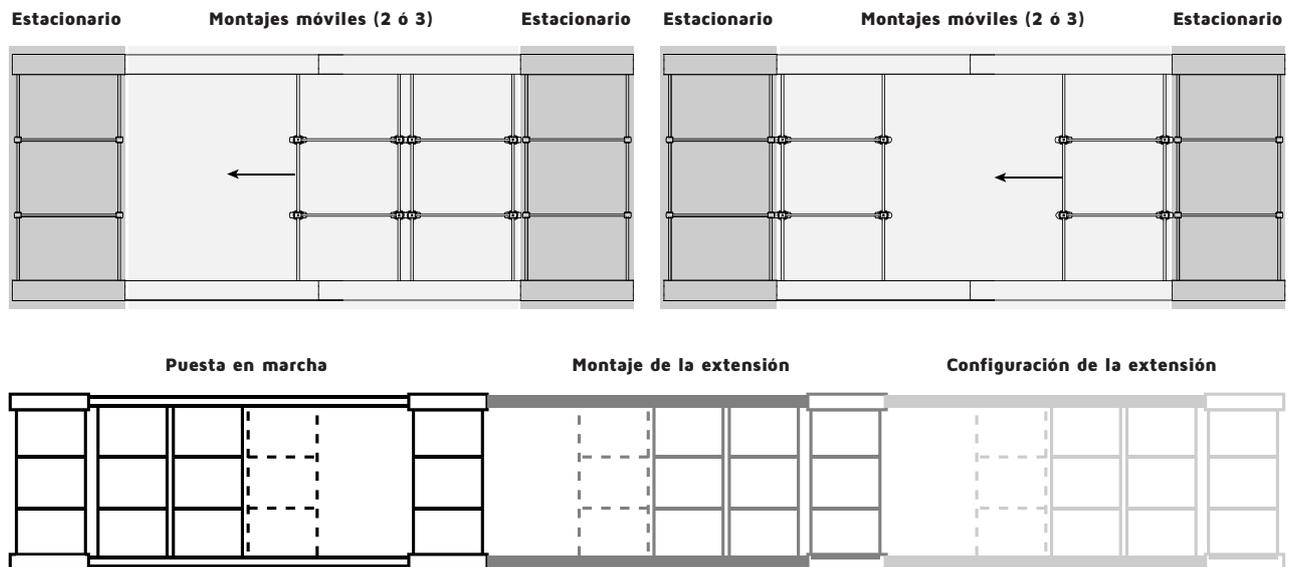
Un UBeTrack™ puede constar de 2 o 3 estantes móviles. La anchura total puede variar, véase la ilustración siguiente. Puede aumentarse en incrementos de 25 mm hasta un máximo de 250 mm, lo que a su vez altera la anchura de la pasarela.
